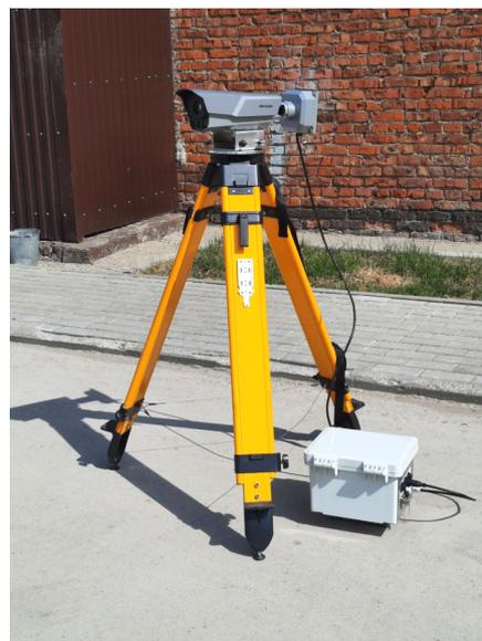
Рис. 5. Внешний вид комплекса в передвижном исполнении
