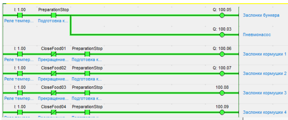
Рис. 5. Симуляция работы релейно-контактной схемы ПЛК
