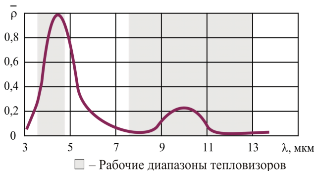
Рис. 2. Нормированный спектральный коэффициент отражения лакокрасочного покрытия
