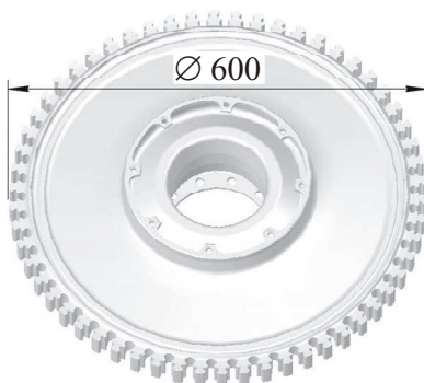
Рис. 1. Диск турбины с елочными пазами
