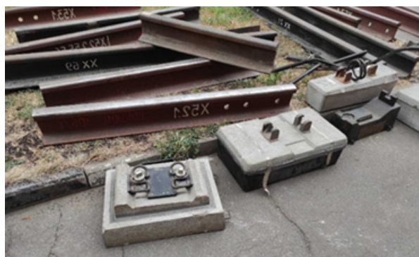
Рис. 3. Возможные инженерные решения для железнодорожного пути городского транспорта с пассивными элементами виброгашения
