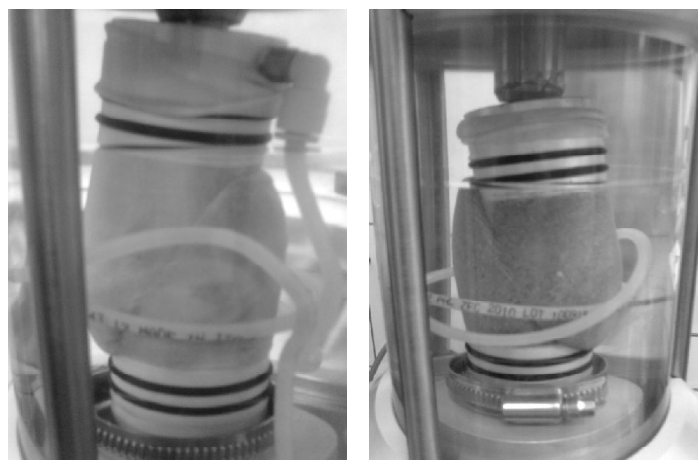
Рис. 4. Характерное разрушение неармированных образцов по поверхности среза
