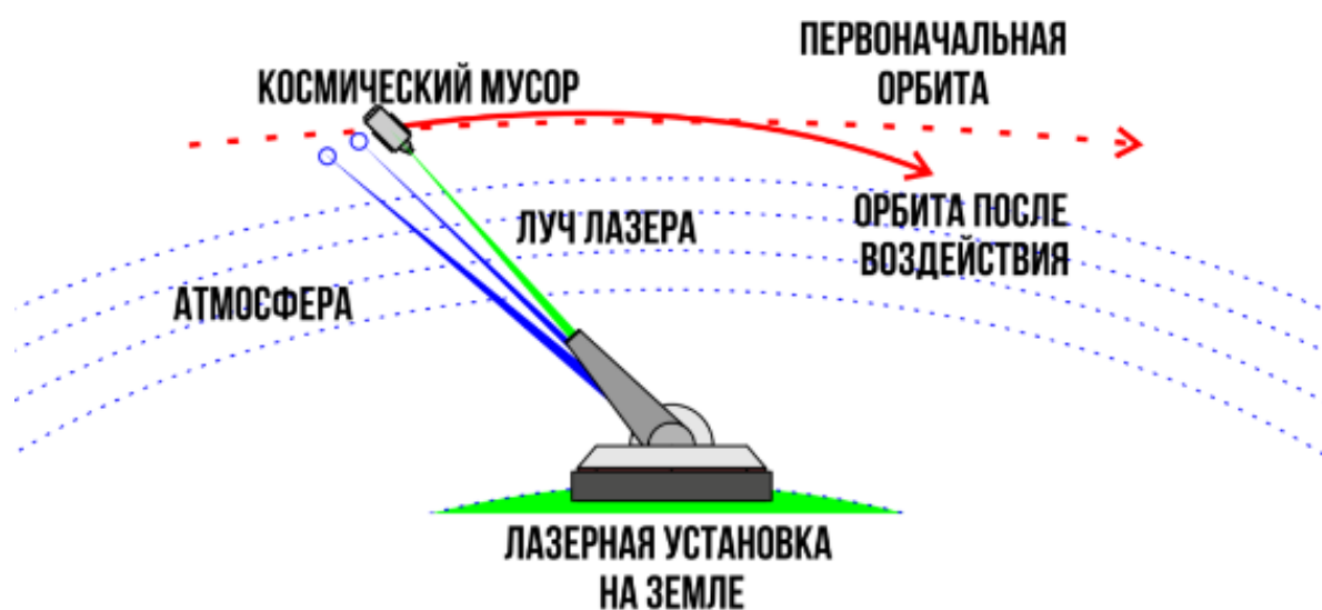
Рис. 5. Принцип действия лазерной установки [11]
