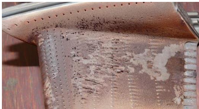
Рис. 17. Стекловидные отложения на корыте сопловой лопатки первой ступени турбины ПД-14, соответствующие воздействию пепла в течение 60 мин при концентрации 4 \text{ мг/м}^3
