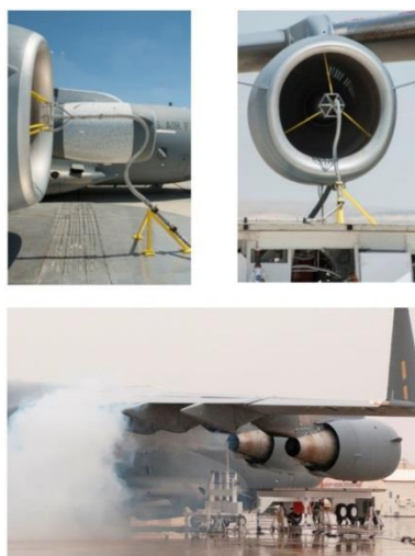
Рис. 13. Установка для испытаний по забросу вулканического пепла в двигатель PW2040 на крыле самолета [3]
