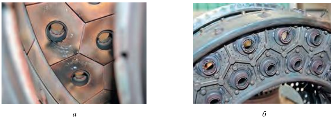
Рис. 18. а – состояние внутренней поверхности жаровой трубы ПД-14; б – состояние внешней поверхности жаровой трубы ПД-14 [16]
