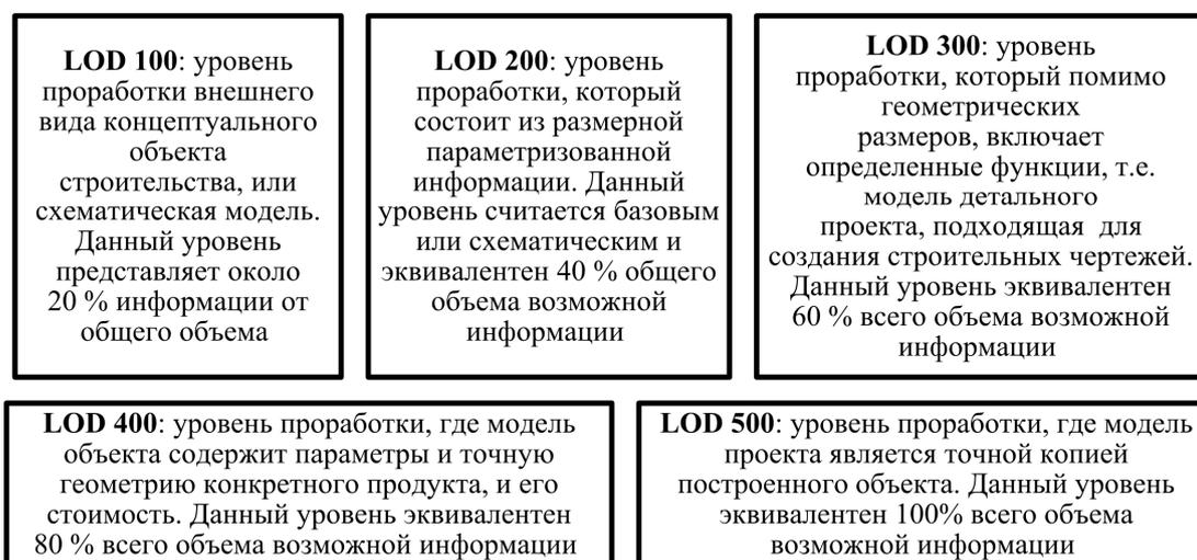
Рис. 3. Уровни проработки элементов модели (LOD)
