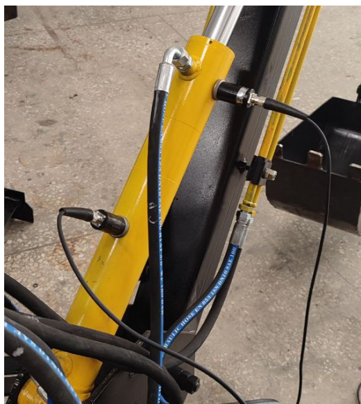
Рис. 2. Датчики ВК-310А на гидроцилиндре
