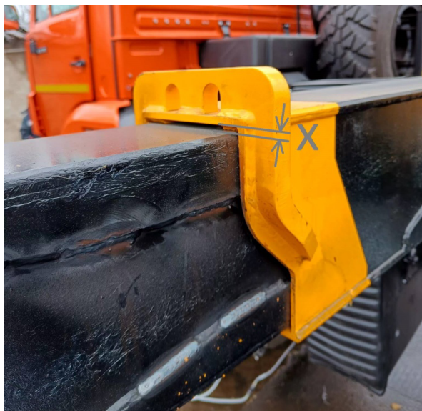
Рис. 2. Секция выдвижения выносной опоры, где X – зазор между сопрягающимися деталями в миллиметрах
