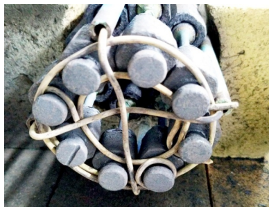
Рис. 2. Обвязка испытуемых образцов с помощью нихромовой проволоки (сплав X20H80)
