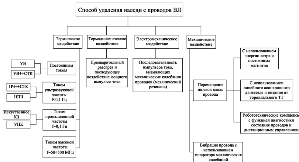
Рис. 1. Классификация методов борьбы с наледью на воздушных линиях электропередачи
