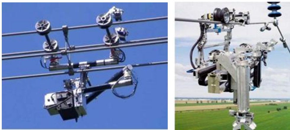
Рис. 4. Роботы Expliner и LineScout для очистки от наледи и мониторинга [ http://elektroas.ru/sostoyanie-linij-elektroperedachi-proverit-expliner ] [ https://robotrends.ru/robopedia/elektroenergetika-i-roboty ] (дата обращения: 25.10.2022)
