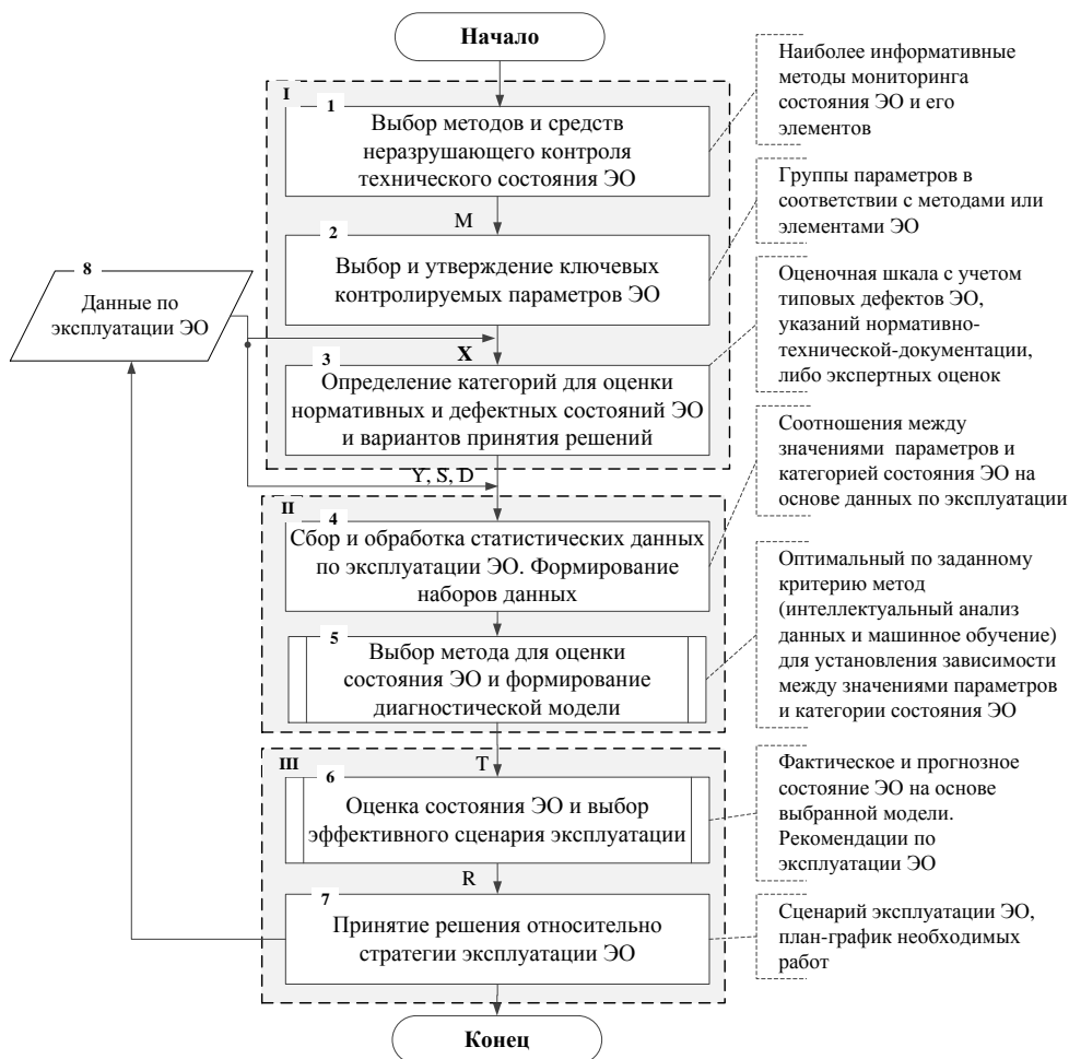
Рис. 2. Блок-схема выбора сценария эксплуатации ЭО в соответствии с фактическим техническим состоянием
