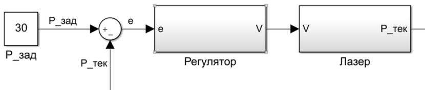
Рис. 3. Структурная схема САУ мощностью лазера, где « $P_{\text{зад}}$ » – задающее воздействие по мощности; « $P_{\text{тек}}$ » – текущее значение управляемой величины (мощности); « $e$ » – отклонение управляемой величины от задающего воздействия; « $V$ » – сформированное регулятором значение напряжения
