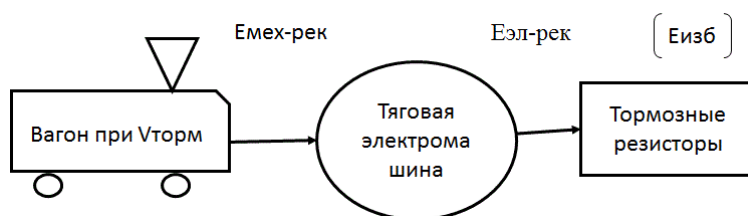
Рис. 1. Этапы преобразования рекуперативной энергии в системе с ЭПС с реостатно-контакторной системой тяги
