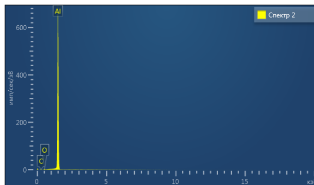
Рис. 8. Химический состав покрытия марки АСД-1
