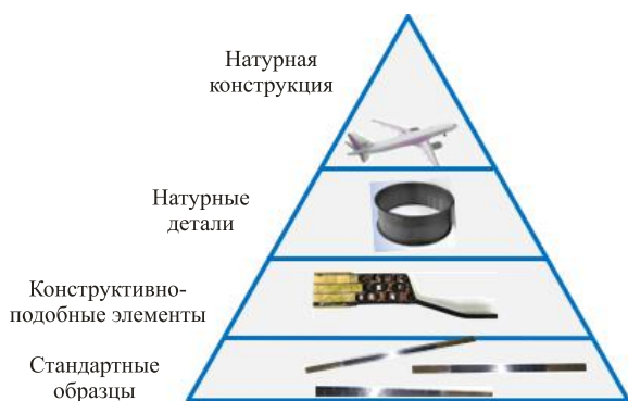
Рис. 1. Схема современной практики обеспечения усталостной долговечности ответственных изделий авиационной техники
