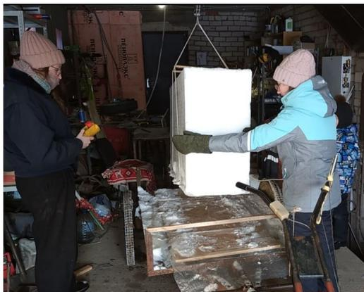
Рис. 5. Подъем снегоблока на стропах
