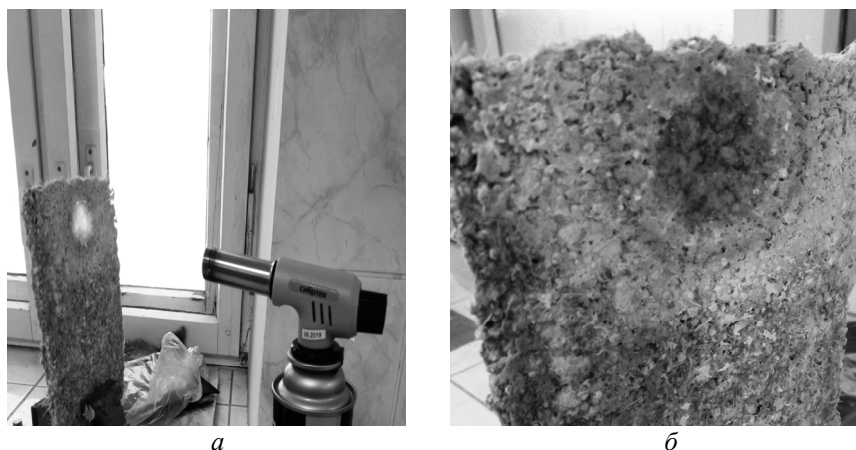
Рис. Материал высококремнезёмистый, теплоизоляционный, огнестойкий, нетоксичный: а – при непосредственном воздействии огня на образец; б – тот же образец после воздействия огня на протяжении 180 мин
