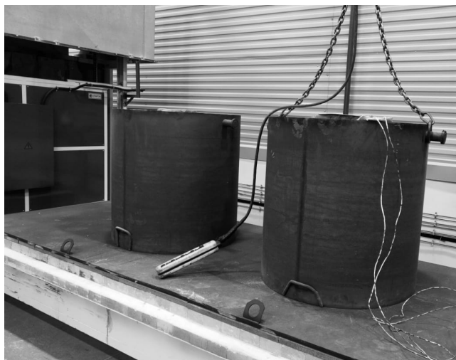
Рис. 1. Контейнер на выкатном поде камерной печи: эскиз и фотография
