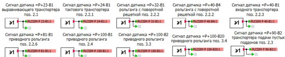
Рис. 12. Фрагмент конфигурации связи между выходами из проекта SIMATIC с входами из проекта TIA Portal
