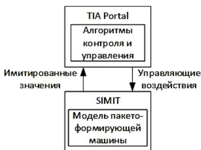
Рис. 5. Тестирование АСУ ТП на модели пакетформирующей машины
