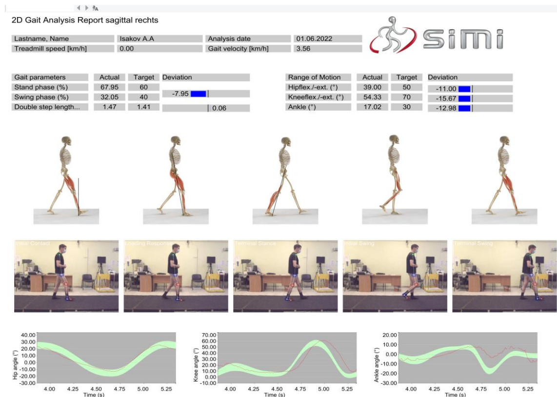
Рис. 4. Отчет «Анализ ходьбы» в режиме 2D, полученный с помощью системы видеоанализа Simi Motion
