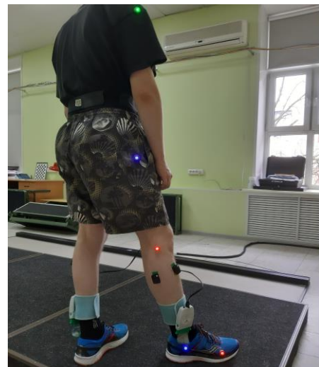
Рис. 2. Пример размещения активных маркеров системы видеонализа SIMI на обследуемом
