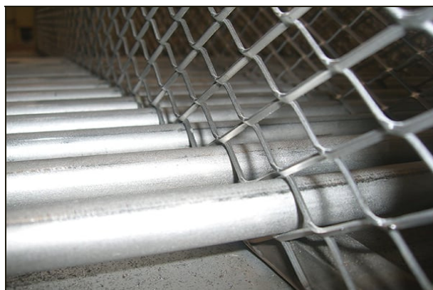
Рис. 2. Теплообменник, в котором трубы проложены через ромбовидные пустоты
