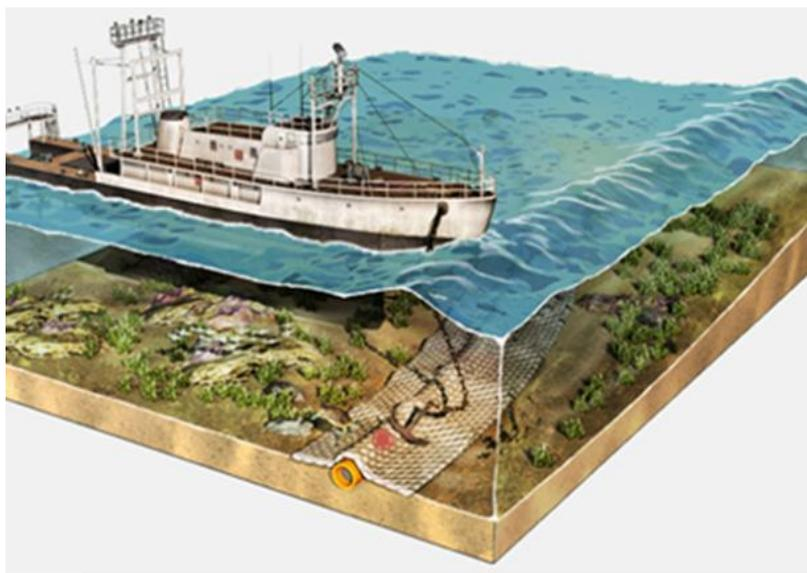
Рис. 2. Защита трубопровода геотекстильными матрасами
