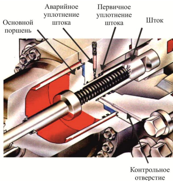
Рис. 4. Узел аварийной герметизации штока
