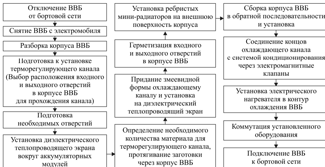
Рис. 5. Блок-схема методики внедрения системы подогрева и охлаждения ВВБ
