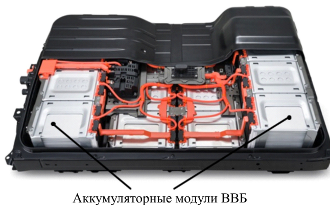
Рис. 4. Высоковольтная аккумуляторная батарея Nissan Leaf
