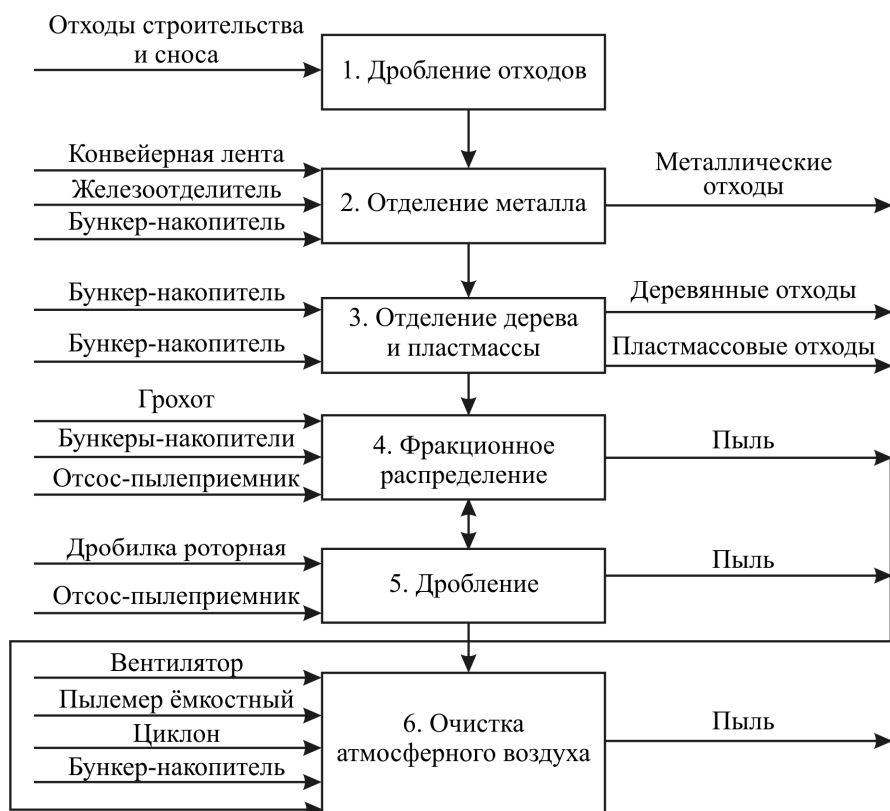
Рис. 3. Схема переработки отходов строительства и сноса
