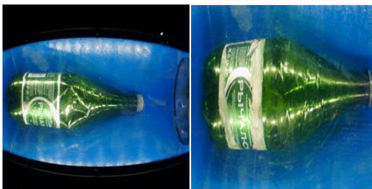
Рис. 3. Пример изображений, поступающих на вход нейронной сети напрямую с камеры и с обрезкой по контурам ROI
