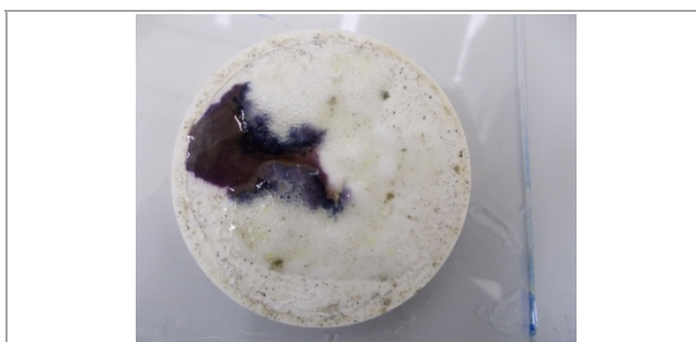
Рис. 4. Изменение цвета йодного раствора, свидетельствующее о наличии крахмала в фильтративной корке
