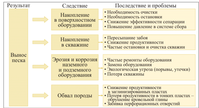
Рис. 3. Последствия выноса механических примесей
