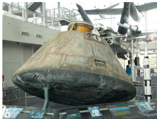
Рис. 1. Обгорание абляционного защитного покрытия
