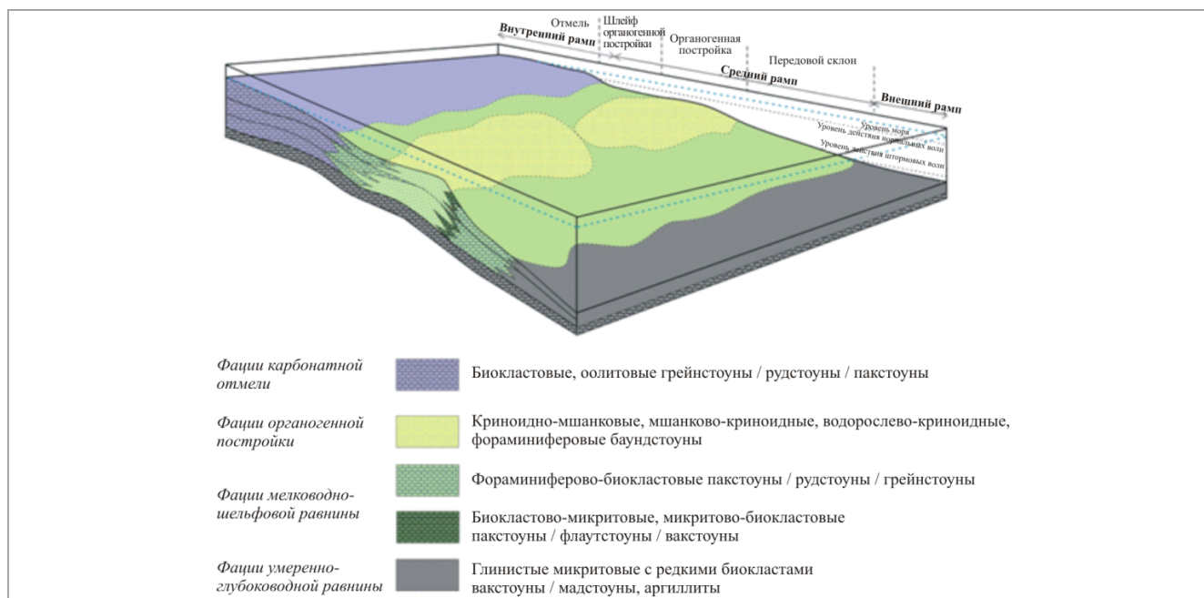
Рис. 3. Концептуальная модель строения каменноугольно-нижнепермских отложений Усинского месторождения
