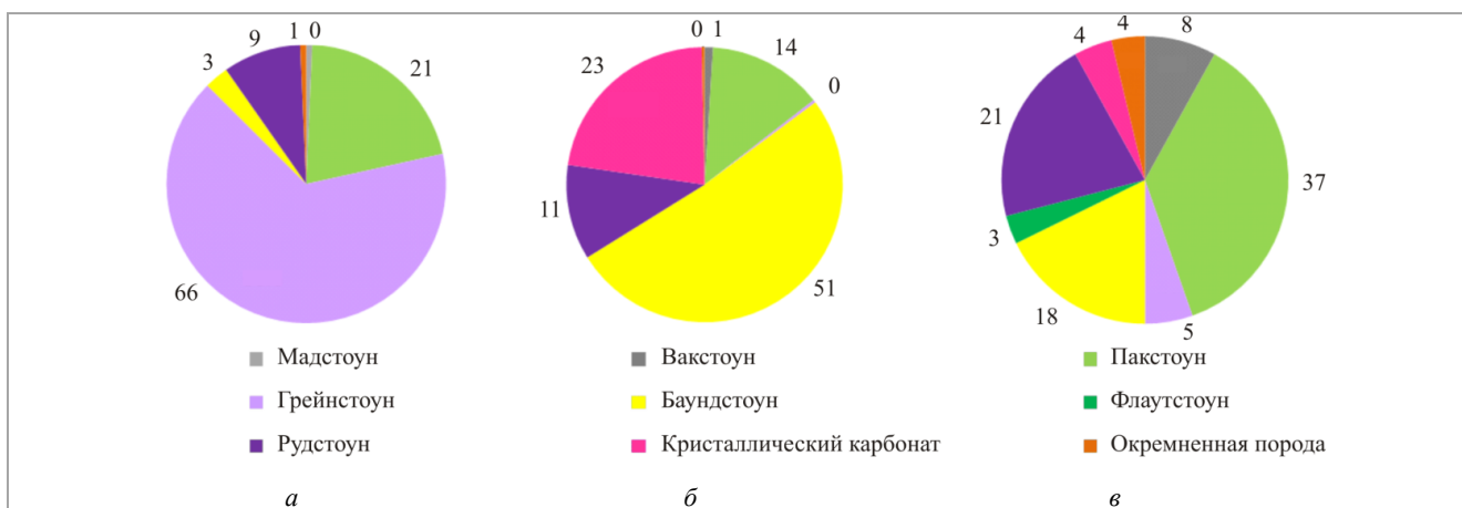
Рис. 2. Наиболее характерное распределение (%) литотипов в скважине для различных фациальных зон: а – карбонатной отмели (зона внутреннего рампа); б – органогенных построек (зона среднего рампа); в – мелководно-шельфовой равнины (зона среднего рампа, частично зона внешнего рампа)
