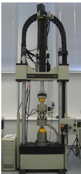
Рис. 1. Испытательная система Instron 8850
