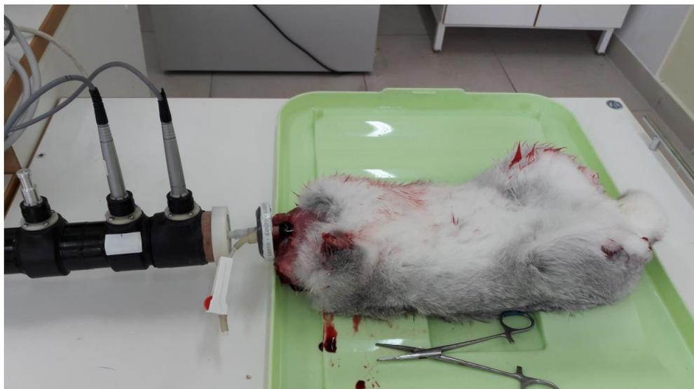
Рис. 2. Измерение импедансных характеристик дыхательной системы кролика
