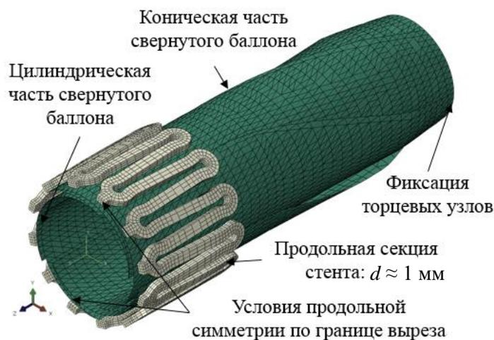
Рис. 4. Расчетная схема: свободное раскрытие секции стента
