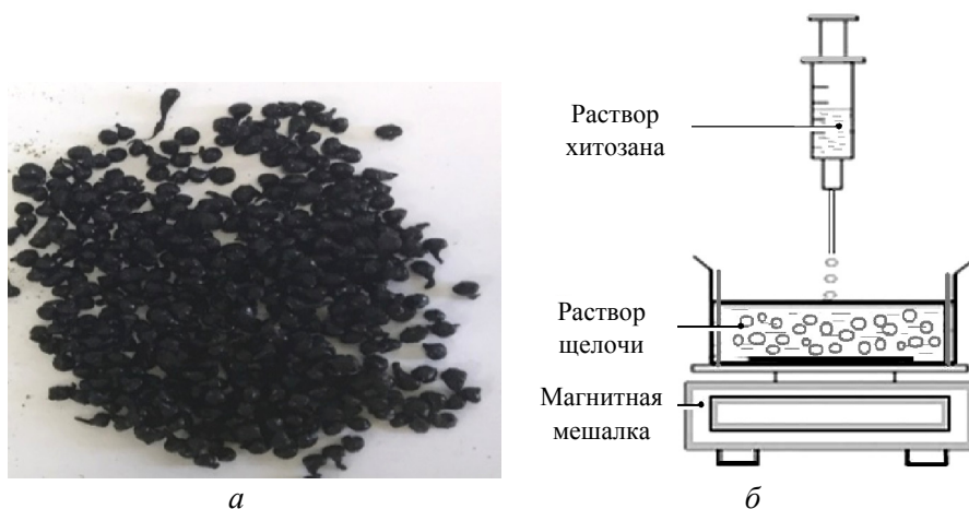
Рис. 5. Вид гранул на основе ТПД и хитозана (а) и процесс их получения (б)
