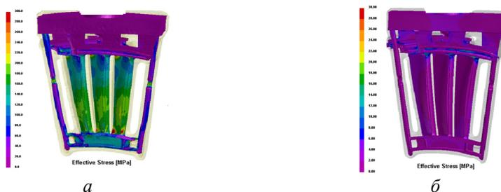
Рис. 6. Остаточные напряжения в кристаллизовавшейся отливке: *a* – при номинальном режиме, *б* – при режиме, полученном в результате исследования
