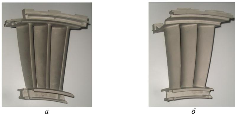
Рис. 2. Трехперая лопатка турбины низкого давления: *а* – корыто; *б* – спинка
