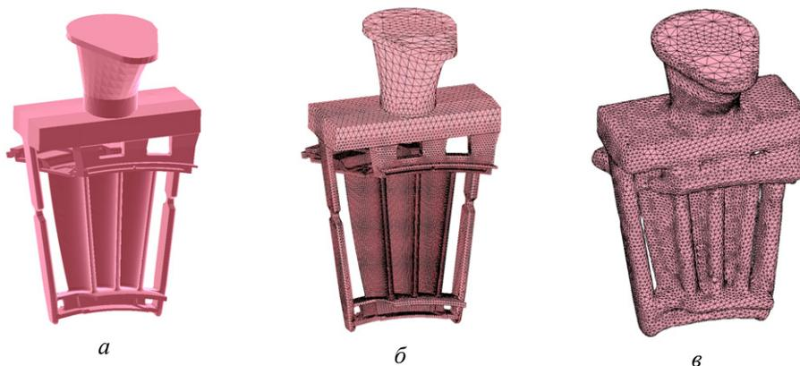
Рис. 3. Формирование расчетной области: *а* – модель отливки, *б* – конечно-элементная модель отливки, *в* – конечно-элементная модель керамической формы
