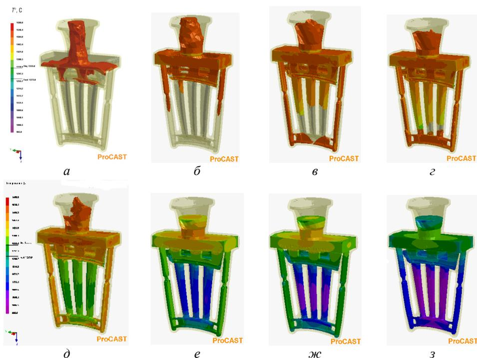
Рис. 4. Температурные поля на отливке в процессе заливки металла в форму и кристаллизации отливки в момент времени соответственно:  $a - 0,4$  с;  $б - 1$  с;  $в - 1,3$  с;  $г - 1,5$  с;  $д - 2,4$  с;  $е - 58$  с;  $ж - 108$  с;  $з - 548$  с
