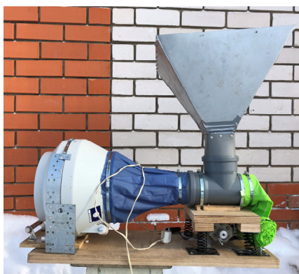
Рис. 5. Пневмотранспортная установка для уборки снега с крыши [18]
