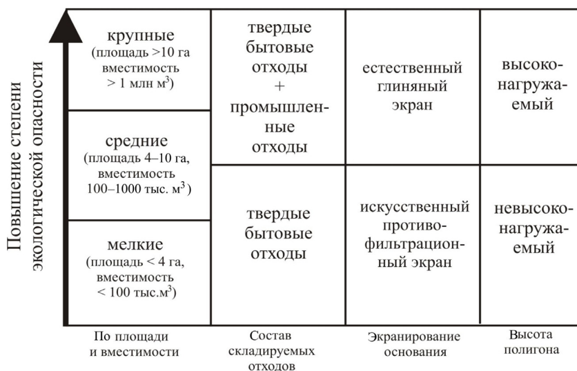
Рис. 4. Рекомендуемые классификационные инженерно-экологические параметры полигонов ТБО, определяющие степень экологической опасности
