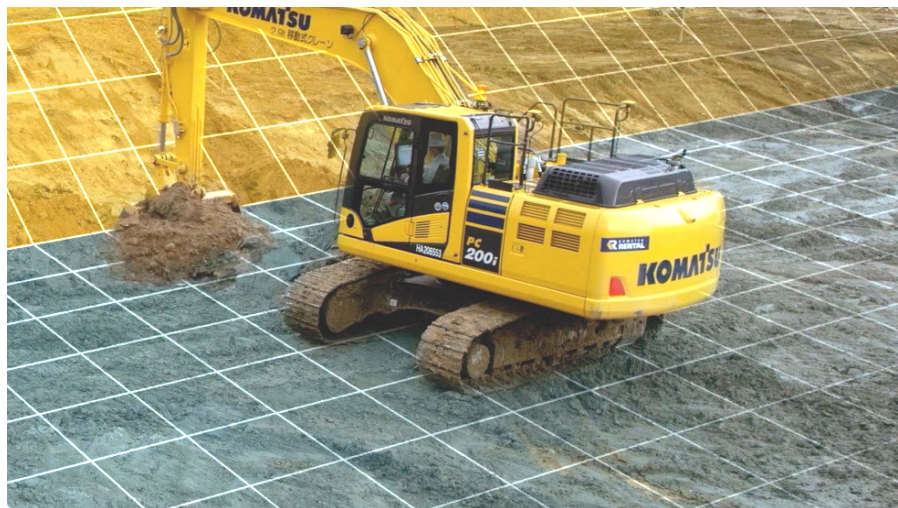
Рис. 2. Пространственная разметка 3D-координат для работы экскаватора [12]
