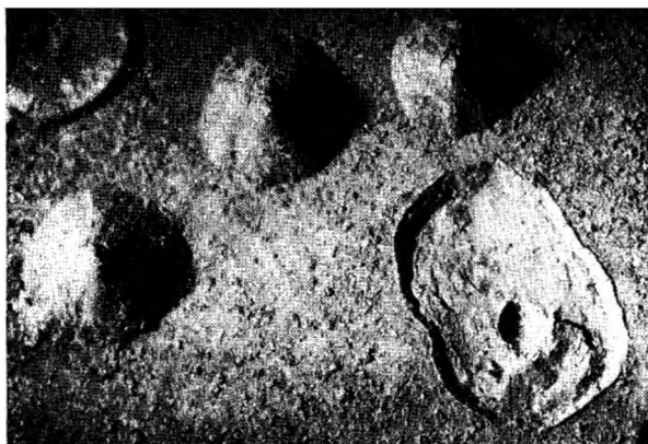
Рис. 5. Очаги локальной коррозии: бугорки и язвы под ними [1]
