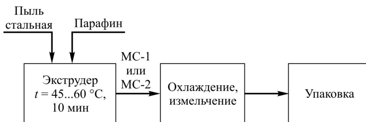
Рис. 2. Технологическая схема получения магнитосорбентов
