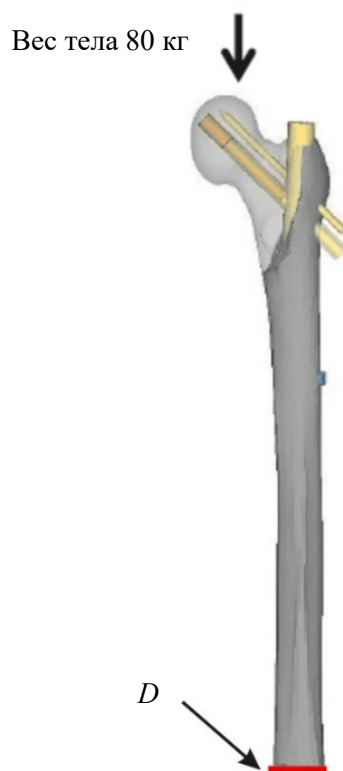
Рис. 3. Модель нагрузки бедренной кости в условиях виртуальной фиксации интрамедуллярным штифтом. Область D – закрепление модели с тремя степенями свободы
