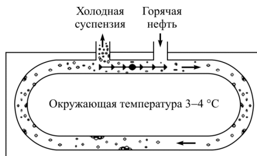
Рис. 6. Схематичное изображение аппарата «Поглотитель парафина»
