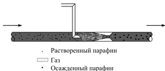
Рис. 7. Схема метода «мгновенное охлаждение»
