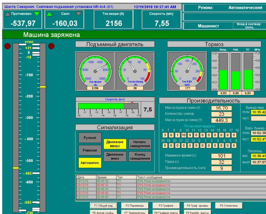
Рис. 3. Экран монитора РПУ-03.5 при работе подъемной установки в ручном и автоматическом режимах
