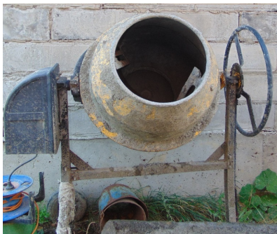
Рис. 5. Бетоносмеситель марки НСМ-650, принятый в качестве экспериментальной модели смесительной установки
