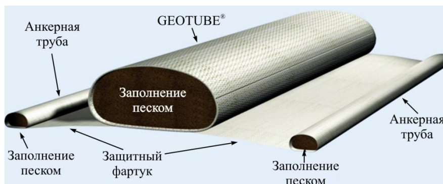
Рис. 1. Поперечное сечение защитного фартука и геосинтетической оболочки Fig. 1. The cross-section of protective apron and geosynthetic sheath
