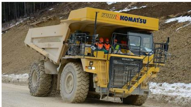
Рис. 3. Троллейвоз (аккумуляторный электросамосвал) Komatsu HD 605-7
