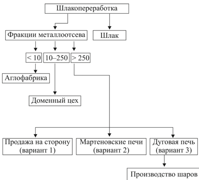
Рис. Общая схема переработки металлоотсева из шлаковых отвалов ОАО «ЧМЗ»
